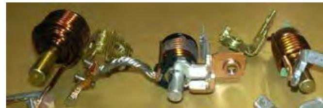
完全電磁式ブレーカーの特性
